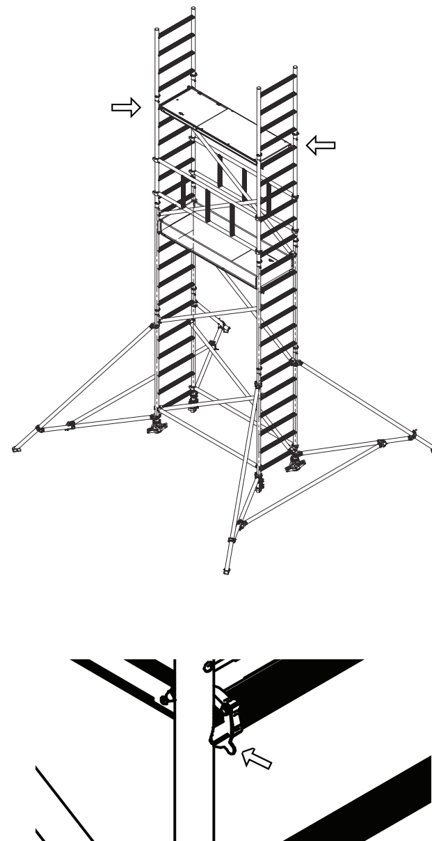
Rys. 48. Montaż podestu oraz blokowanie
