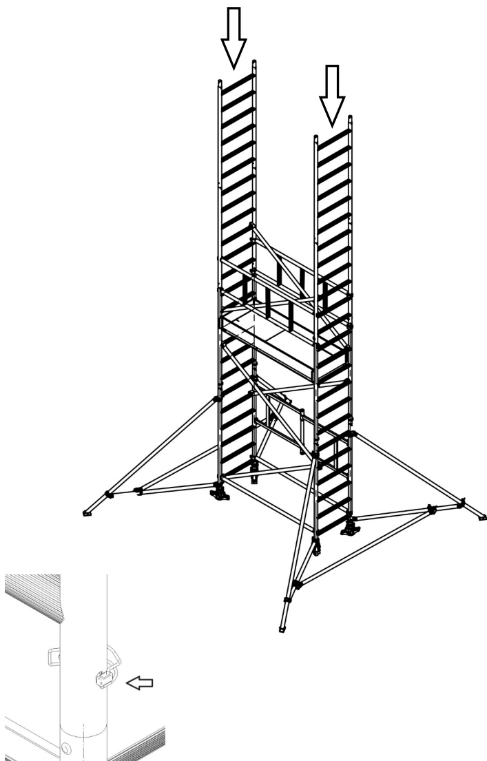
Rys. 81. Montaż drabin oraz blokowanie
